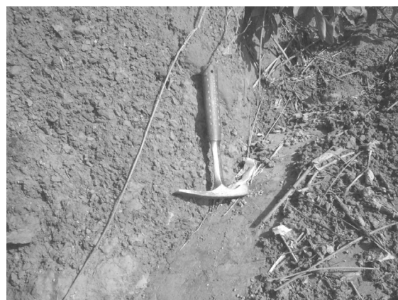
写真一2 崩壊の発生源。基岩にへばりついた旧崩土が流出した。 写真一3 旧崩土がシャープな面を境に基岩の上に載る。湧水を伴う。
