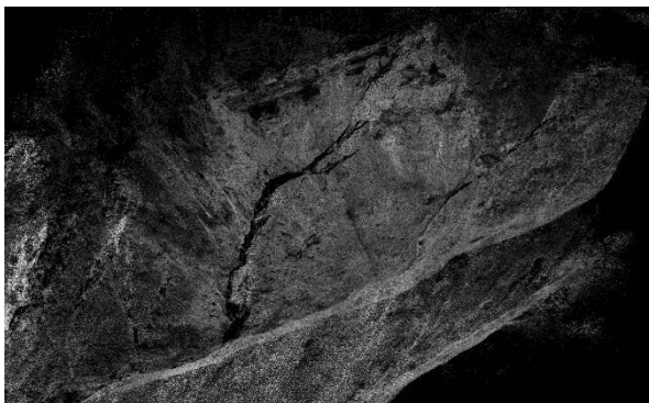
図-14 地上型レーザスキャナーによる計測データ
