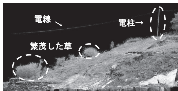
図-5 計測データに含まれる障害物
