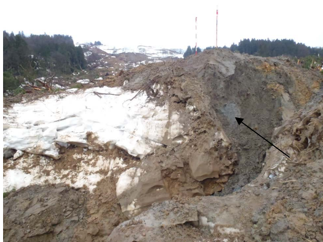
写真 17 移送堆積域左側部のトレンチ箇所 移動土塊が雪の上に乗りあがる。
