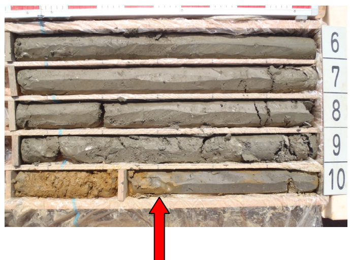
(6) BV24-7 号孔 (すべり下端深度 GL-9.65m) 下に沖積粘土
