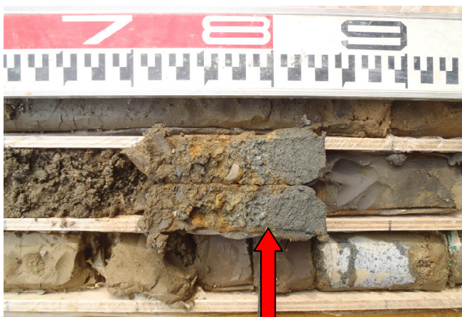
(5) BV24-6 号孔 (すべり下端深度 GL-11.8m) 下に沖積粘土
