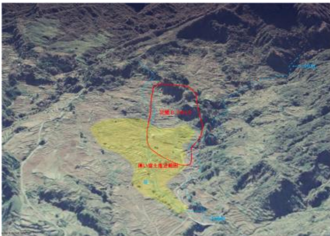
図 5. 2 ほ場整備前の地形と災関 B ブロックの関係 (S51 撮影空中写真を SfM 解析で 3 次元化)
